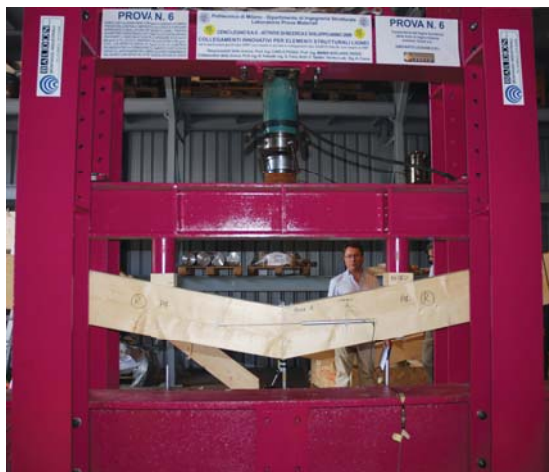
Fig. 4 - Campione predisposto da SIMONATO LEGNAMI Prova n. 6 a cura del Laboratorio Prove Materiali del Dipartimento di Ingegneria Strutturale del Politecnico di Milano
